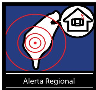
Un sistema de alerta temprana para Terremoto (EEWS por sus siglas en inglés) consiste en acelerómetros, medios de comunicación y servidores que en conjunto proporcionan información para una Alerta temprana. Debido a que la onda P es casi el doble de veloz que la onda S, el sistema es capaz de enviar alertas rápidas. Dependiendo de la distancia entre el epicentro y la ubicación de los usuarios, el tiempo de alerta temprana puede variar.
